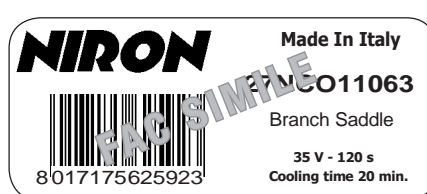
FIG.6 MANUAL WELDING PARAMETERS
